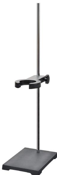
Support avec pied de 13 mm de diamètre et 610 mm de haut et fixation pour convertisseur.
