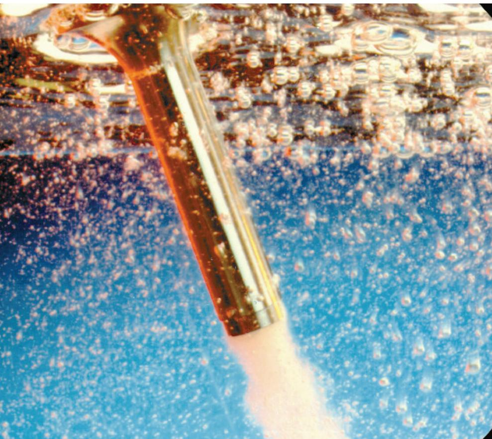
faible puissance. Les volumes plus importants, quant à eux, nécessitent des sondes plus grosses et une plus grande quantité d'énergie.
