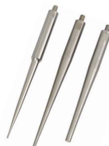
Sondes pour un traitement par ultrasons direct d'échantillons de 1 000 ml maximum.
